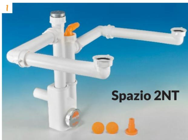
**1.** Nel caso di lavelli a due vasche è indicato Spazio 2NT che raddoppia i tubi di presa, entrambi con attacco da 1½". Questi si raccordano nel sifone che ha profondità di soli 85 mm e larghezza di 100 mm. In testa a ognuno dei due tubi di discesa vi è il raccordo bpasso per lo scarico di eventuali lavatrici e/o lavastoviglie. Disponibile nei colori bianco e grigio metallizzato.
