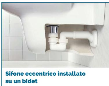
• **Il sifone eccentrico di LIRA** è nato per rispondere alle esigenze specifiche dell'installatore ed è strutturato in modo da agevolarne il più possibile l'operazione di installazione. Il sifone eccentrico ha una rotazione di 3,5 cm che ne permette un agevole inserimento nel foro di scarico, persino nel caso in cui quest'ultimo non si trovasse in asse.
